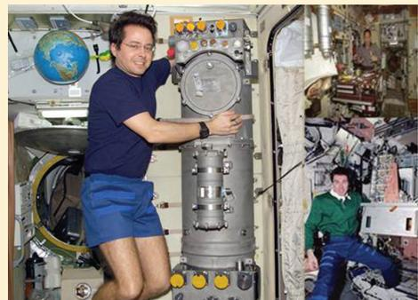
이소연 우주인이 머물렀던 ISS의 산소는 물을 전기 분해하는 엘렉트론이라는 장치로부터 얻는다. 엘렉트론은 즈베즈다 모듈에 설치되어 있다. 엘렉트론이 고장 날 경우 즈베즈다 모듈의 오른쪽 벽에 붙어 있는 은색의 원통과 같이 생긴 교체 연료 산소 발생기를 이용한다. 우주선에서는 산소를 만드는 만큼이나 우주인이 배출하는 이산화탄소를 없애는 것이 매우 중요하다.
