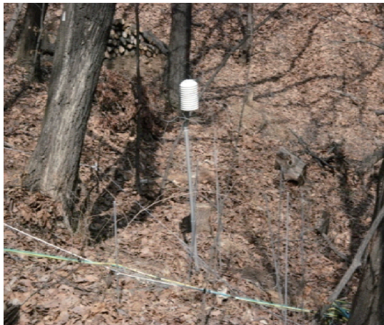
그림 9.6 남산 생태 관측지소에 설치된 환경요인 (기온, 지온 및 토양수분) 측정 시설.
