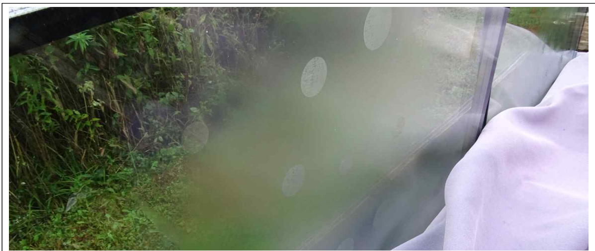
<23> 조류에게 인지 가능한 자외선 반사패턴을 원형으로 입힌 유리 활용 사례 (미국 파우더밀 조류가락지 부착센터에서 시험 중인 아놀드유리 시안. 좌 상단이 정상 부위고 원형 무늬는 자외선 반사면이 드러날 수 있도록 입김을 불어서 촬영)
