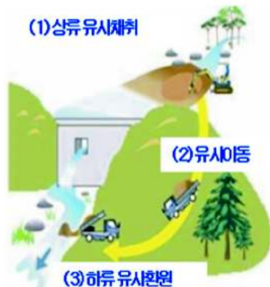
〈그림 4〉 댐하류 유사환원 사업 모식도
