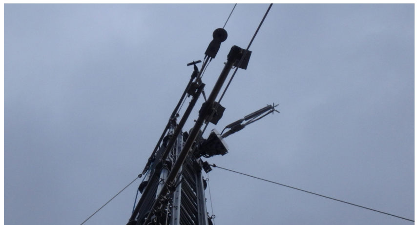
점봉산의 지표면으로부터 생태타워 33 m 및 31 m의 고도에 설치된 주요 Open-path (Model: EC150) and Enclosed-path (Model: LI-7200RS) CO 2 /H 2 O analyzers와 3D ultrasonic 초음파풍향풍속계(Model: CSAT3 and WindMaster PROc).
