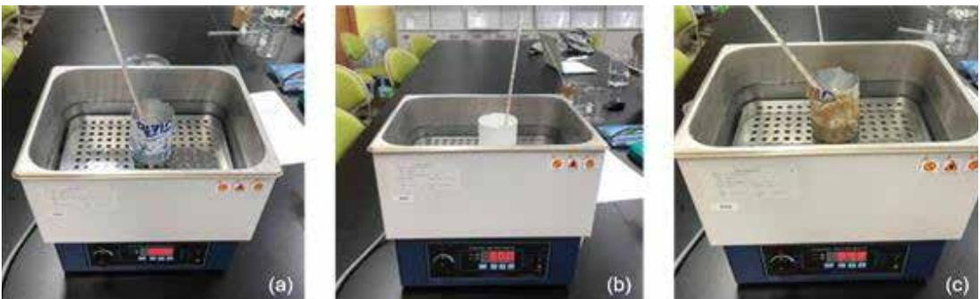
그림 6. 열전도도 측정 과정: (a) 대조군, (b) 실험군 1, (c) 실험군 2
