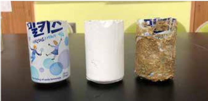
그림 5. 벯짚 페인트의 단일 성능 평가를 위한 대조군·실험군 제작 결과
