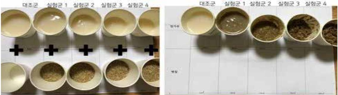
그림2. 밀가루 풀과 벃짚의 혼합 비율에 따른 대조군·실험군 제작
