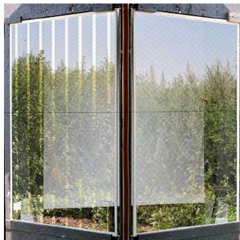
현재 프라운호퍼 태양에너지시스템연구소(ISE)에서 개발 중인 이 표식은 투명한 줄무늬를 표면 1에 인쇄했으며, 조류충돌 예방 효과가 매우 뛰어난 것으로 나타났습니다(왼쪽: 평가 창, 오른쪽: 대조 창). ©Martin Rössler
