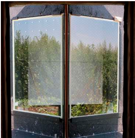
Eastman Saflex® FlySafe™ SEEN shiny 9/90: 금속성 도트, 지름 9mm, 간격 90mm: 매우 효과적이며 반사율이 높아 표면 2(왼쪽: 평가 창, 오른쪽: 대조 창)에 인쇄하여도 효과가 뛰어납니다. ©Martin Rössler
